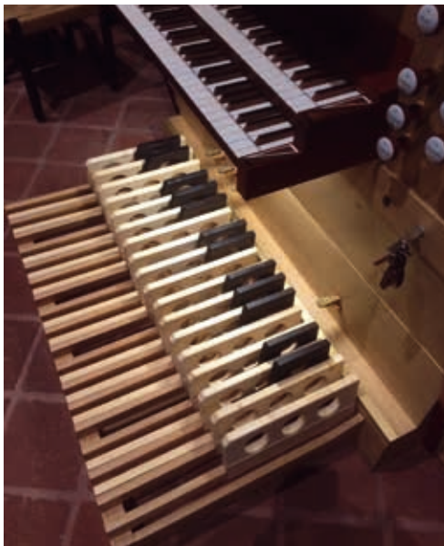
Das Kinderpedal besteht aus Tasten, die auch einzeln auf das Orgelpedal aufgesteckt werden können.
